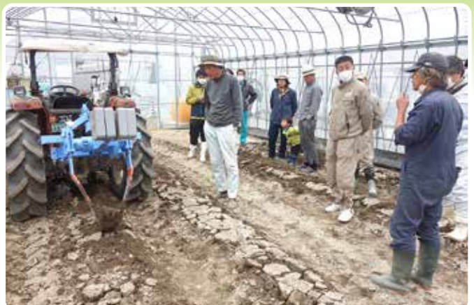
カットブレーカーによる心土破碎実演。 V字の刃で心土を持ち上げて破碎する。
